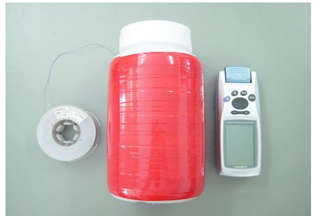
写真-2 観測機材 (係留紐, 浮標, GPS)
