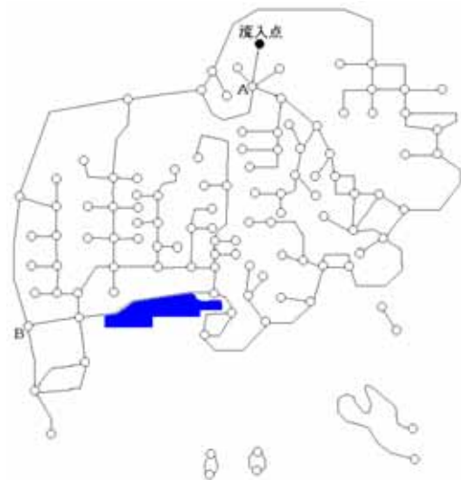
図5 地下排水管のモデル
