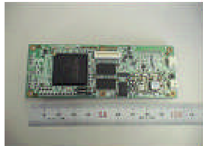
図-1 探査ロボットの映像伝 送表示システム
