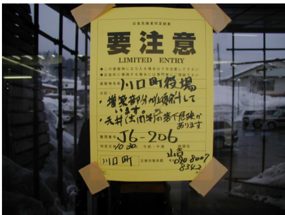
写真. 24 要注意と判定された役場のステッカー 一（川口町）
