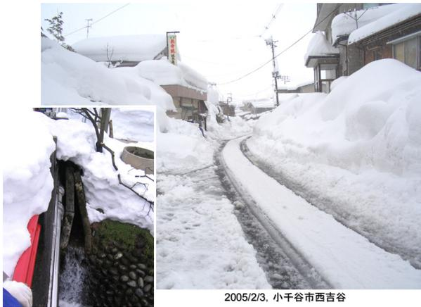
写真11 流雪溝流末部の損傷により使用自粛の行政指導がなされた路線。両脇に屋根からおろした雪が積みあがり1車線しか通れなくなった (2005/2/3, 小千谷市西吉谷)。
